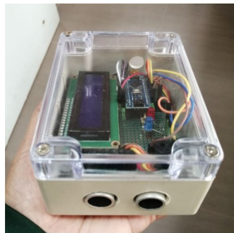
Rajah 10 (b): Kedudukan penderia ultrasonik pada pengukur
